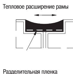
Рис. 5 Расположение разделительного жгута пленки для предотвращения крепления уплотнителя к трем поверхностям
