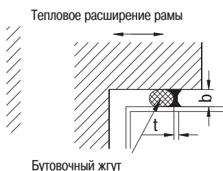
Рис. 4 Разрез по плоскости уплотнения (нагрузка на срез)
